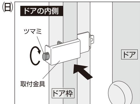
(日)取付金具をドア枠にはめ、ツマミを回してドア枠にしっかり固定し、ドアを閉めるときに取付金具とドアが当たらないか確認します。
