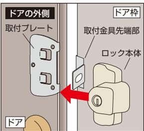
ドアに取付プレートを両面テープで貼り付け、そこにロック本体を装着して完了。
