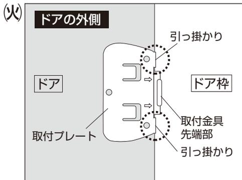
(火)取付プレート裏の両面テープをはがし、取付プレートの矢印と取付金具先端部が合うように貼り付けます。この時、取付プレートにある2ヶ所の引っ掛かりが扉の角にピッタリ合うように押しつけてください。
