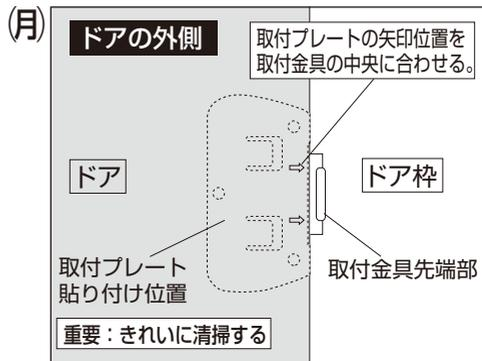
(月)取付金具を付けたままドアを閉め、取付プレートの矢印を参考に取付プレートの貼り付け位置を確認し、必ず取付位置のドア表面の汚れをきれいに除きます。
