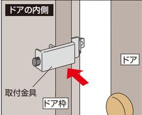
取付金具をドア枠に固定します。
