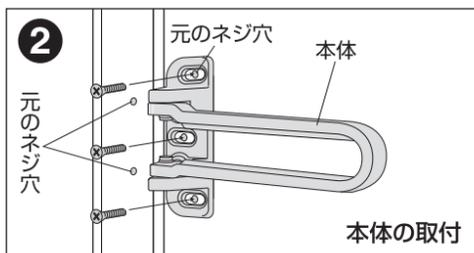
外した後のネジ穴に本体を合わせて、ネジ止めて
