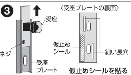
ネジをゆるめて受座を外します。受座プレートの裏
