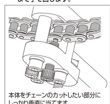
1 ボルト先端の中心部とチェーンのピンの中心部が合うように回してください。中心がずれた状態でボルトを回すと本体が変形する原因になります。
